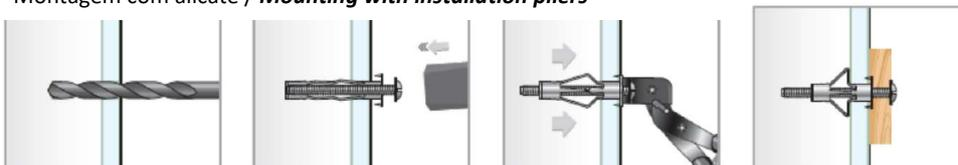
É crucial garantir que o diâmetro do furo pré-perfurado é respeitado antes de instalar a cavilha, bem como a utilização de anilhas largas DIN 9021 M6 zincadas para garantir uma fixação correta.
