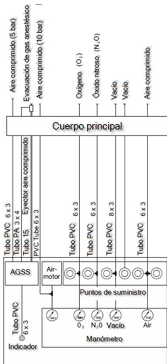
13 pav. Dujų vamzdžių ir anestezijos dujų evakuacijos sistemų prijungimo pavyzdys
